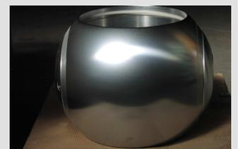
Kugelhähne (ca. 3to) einer Pipelinearmatur hartverchromt.
