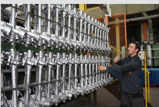
Lenkgehäuse aus Aluminiumdruckguß werden eloxiert und verdichtet.
